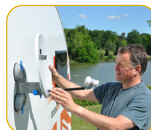
SAT Spiegel auf die Halterung stecken und anschließend ausrichten
